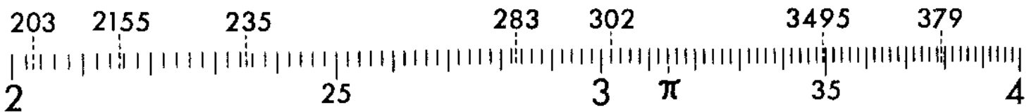
Abb. 8 Ablesen im Bereich von 2 bis 4
